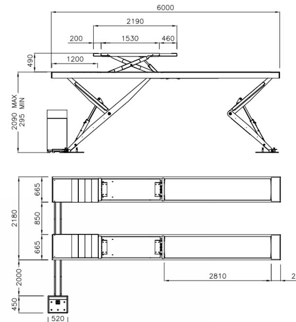
**WX60 pont élévateur électrohydraulique**
