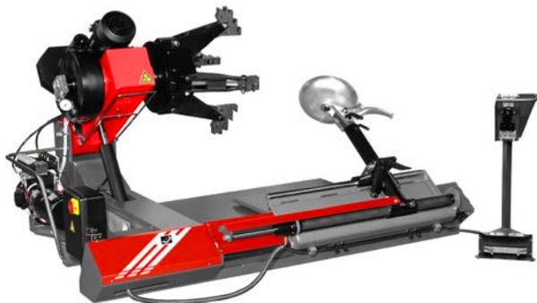
**Smonta gomme elettro-idraulico indicato per operare su ruote camion e bus, con cerchio tubeless, a canale ed anello e cerchietto da 14" a 42"**
