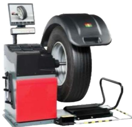
Nuova generazione di equilibratrici ad alte prestazioni elettronica progettate per operare su ruote autocarro, autobus, vettura e moto grazie al sistema a doppia velocità di rotazione automaticamente selezionata in base al tipo di ruota.
