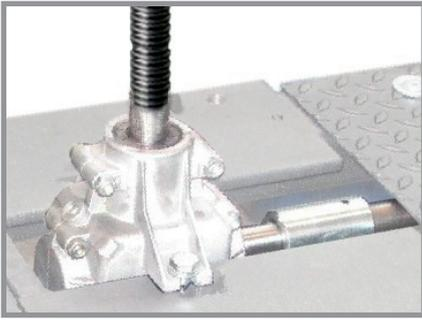
Trasmissione fra le colonne tramite barra rotante e scatole angolari con ingranaggi conici a bagno d'olio che non richiedono alcuna manutenzione
