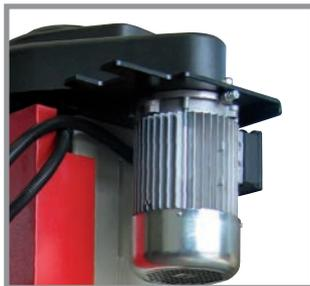
Due motori speciali autofrenanti ad alto rendimento per garantire potenza e durata nel tempo, dotati di sonda termica di protezione
